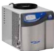
卓上型 除湿量 2.5L    トラップ  $-50^{\circ}\text{C}/-84^{\circ}\text{C}$
